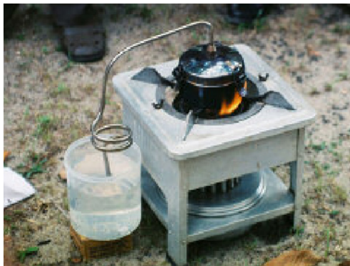
Las retortas son populares con los mineros ya que pueden reciclar su mercurio.
